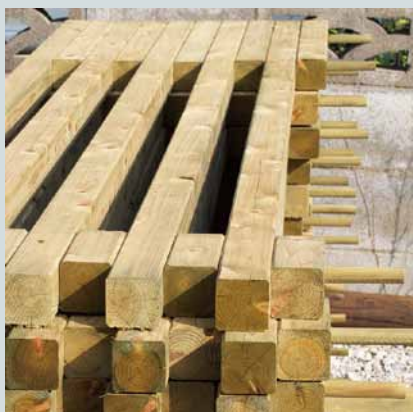
パネル化して加圧注入釜で防腐処理
